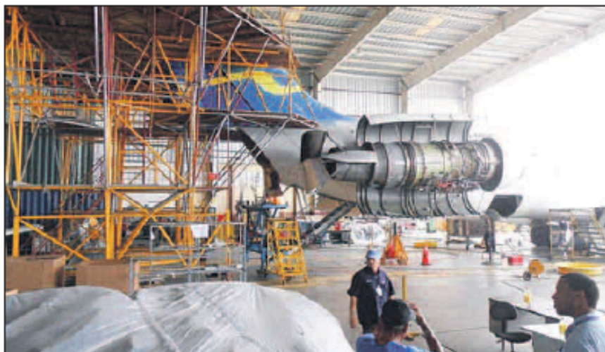
Een onderzoek en revisie van de rechtermotor alsook het controleren op corrosie binnen de motor.
